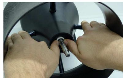
11. Graphitteil mit Feder und Balg aufsetzen.
