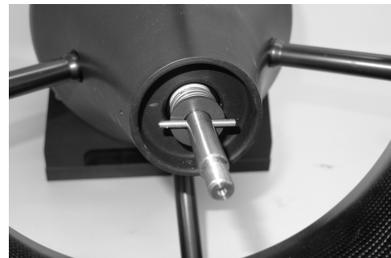
5. Scherstift seitlich entnehmen und Feder mit Dichtungsbalg abziehen.
