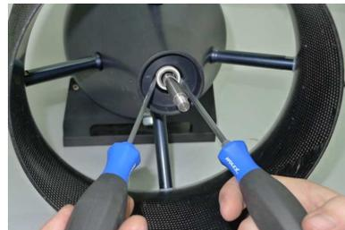
7. Defekten / alten O-Ring entfernen.
