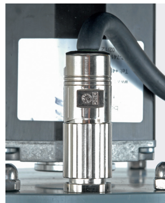
Die Verbindung zwischen Akku und Motor. Hier wird auch das Ladekabel angeschlossen.
