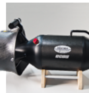
Als Update ist eine Tube aus Carbon erhältlich, die bis zu 200 Meter tiefe Tauchfahrten ermöglicht.
